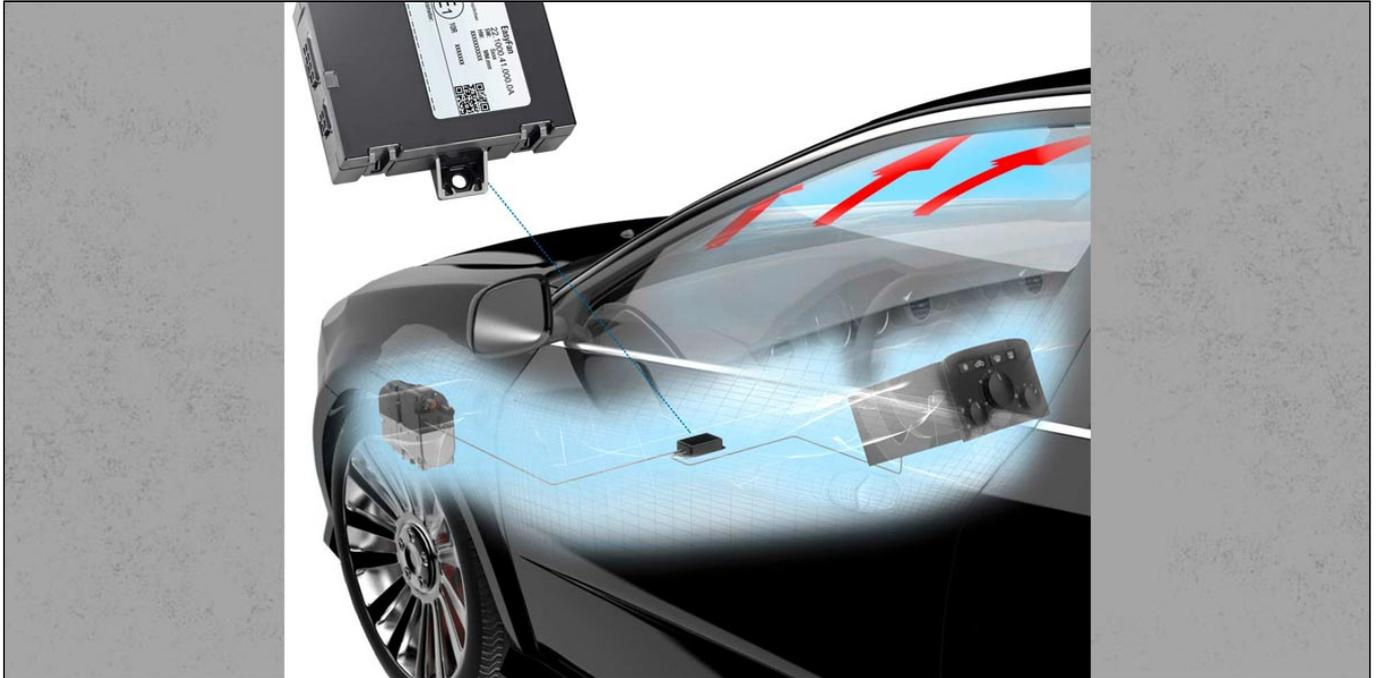
Der Thermomanagement-Spezialist Eberspächer verspricht mit seinem neuen Steuergerät EasyFan einen komfortableren und effizienteren Betrieb seiner Standheizungsmodelle Hydronic 1 und 2.
