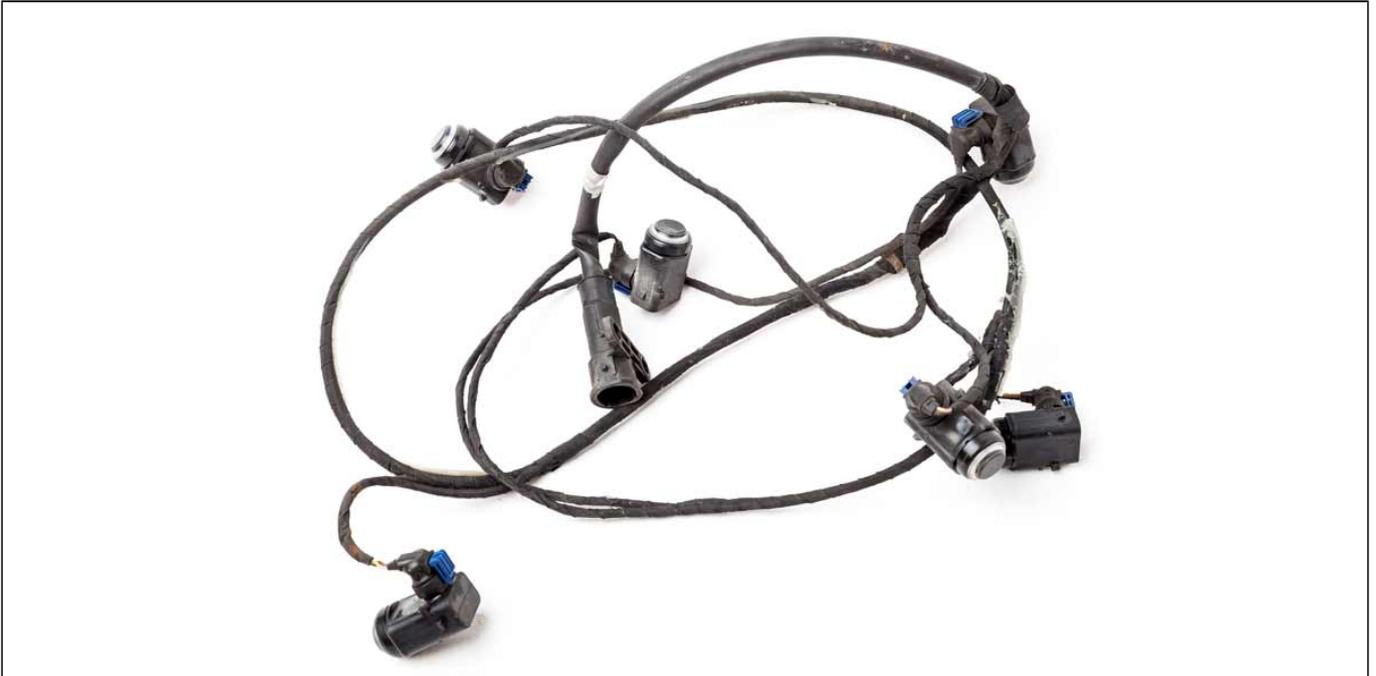
Das Piepen, das den Fahrer beim Rückwärtseinparken vor einer möglichen Kollision warnt – ein Luxus, den niemand vermissen will, wenn man sich einmal dran gewöhnt hat. Die Einparkhilfe gehört zu einer der beliebtesten Extras in neueren Fahrzeugen und kann auch bei älteren Fahrzeugen nachgerüstet werden. Deswegen äußern auch viele Kunden in den Werkstätten den Wunsch über eine Nachrüstung bei ihrem Fahrzeug. Wir geben Ihnen einen allgemeinen **Überblick zum Thema Einparkhilfe nachrüsten**.
