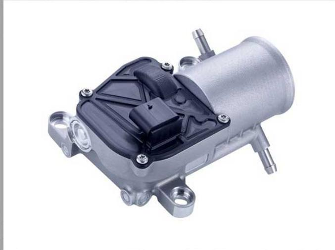
Die Firma Pierburg entwickelt neue Wastegate-Aktuatoren, die direkt auf der Abgasturbine sitzen. Bisher haben die Aktuatoren über eine Schubstange die Bewegung vom Aktuator auf das Ventil übertragen. Die mechanische Ansteuerung verschliss mit der Zeit und wurde ungenau – ein guter Grund für eine Neuentwicklung.
