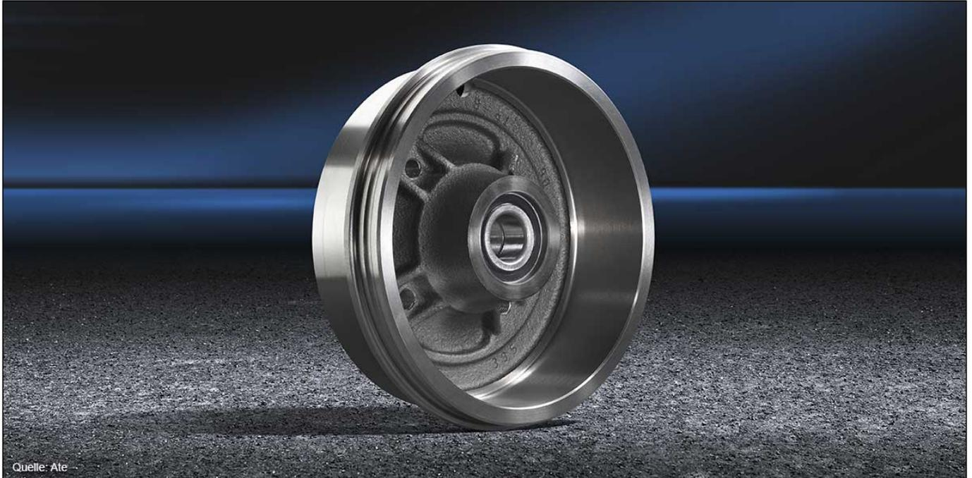
Seit Herbst letzten Jahres gilt die Norm ECE-R90 („Ersatzbremsbelag-Einheiten für Kfz und Anhänger“) auch für Bremsscheiben und Bremstrommeln und heißt seitdem ECE-R90-02. Die Norm schreibt jetzt auch die Zulassung für Bremsscheiben und Bremstrommeln vor, die als Ersatzteile für neu zugelassene Fahrzeuge verwendet werden. Die neue Regelung gilt europaweit.
