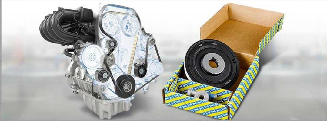
Warum muss die Schraube mit der gedämpften Riemenscheibe eigentlich auch immer erneuert werden? Der Hersteller sagt, dass beim Austausch der gedämpften Riemenscheibe oftmals hohe Anzugsmomente aufgebracht werden. Damit die Zugkraftverluste vom Gewinde bis zum Schraubenkopf ausgeglichen werden, ist bei bestimmten Anwendungen sogar ein zusätzlicher Anzugswinkel erforderlich.
