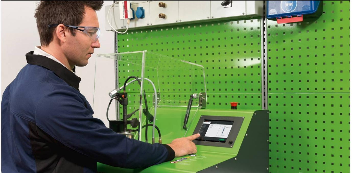
Der neue vollautomatische Tester EPS 118 von Bosch hat viele Vorteile. Er ermöglicht zum Beispiel schnelles Aufspannen und Prüfen, ist für Injektoren aller wichtigen Hersteller geeignet und unterstützt die präzise Prüfung nach dem „Check and Change“-Prinzip. Außerdem lassen sich die Prüfergebnisse für den Kunden in der Werkstatt einfach anzeigen. Da immer mehr Fahrzeuge mit Common-Rail-Systemen ausgerüstet sind werden Reparaturen an diesen Systemen für Kfz-Werkstätten zunehmend attraktiv.
