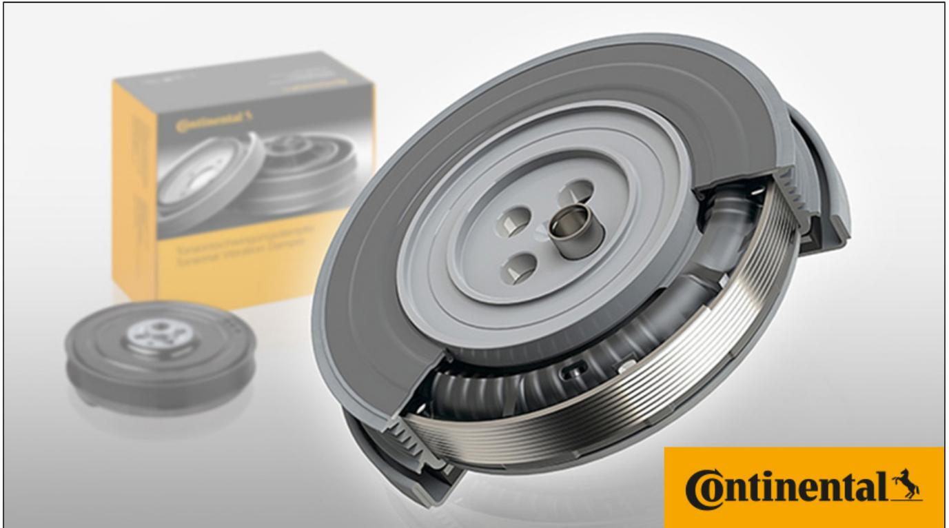
Die Kurbelwelle erzeugt Schwingungen und Drehungleichförmigkeiten, die sich über Riemenscheibe und Riemen auf den gesamten Riementrieb übertragen, was eine Belastung für sämtliche Aggregate darstellt. **Die Torsionsschwingungsdämpfer (TSD)** von [Continental](#) eliminieren diese Schwingungen dank ihrer integrierten Gummispur und schonen so Riemen und Aggregate.
