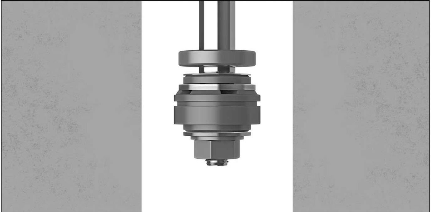
Mit seiner PCV-Technologie zeigt ZF, wie sich Fahrkomfort und -stabilität bei der Fahrwerksauslegung von Bussen zu einer geräuschoptimierten und kostenbewussten Lösung vereinen lassen. Diese kommt nämlich als rein hydraulischer Schwingungsdämpfer ohne elektrische oder pneumatische Zusatzsysteme aus.
