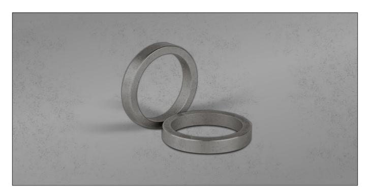
Ventilsitzringe haben enorm an Bedeutung gewonnen, seit Zylinderköpfe aus Aluminium hergestellt werden. Sie dichten den Brennraum zusammen mit den Ventilen des Zylinderkopfes ab und verhindern außerdem das Einschlagen/Eingraben des Ventils in den Zylinderkopf. Ein Teil der Verbrennungswärme wird vom Ventilsitzring aufgenommen und an den Zylinderkopf abgegeben.
