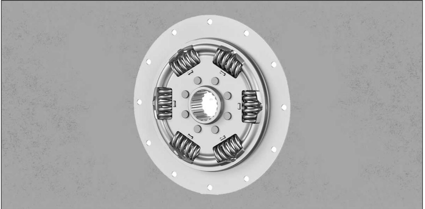
Die Kraftübertragung zwischen Motor und Getriebe unterliegt hohen Anforderungen: Bei einer **Schaltkupplung** sind es zum Beispiel das schnelle und zuverlässige Trennen und Schließen des Kraftflusses, ruckfreies Anfahren, Dämpfung von Motorschwingungen, angenehme Bedienbarkeit, hohe Lebensdauer ohne Komforteinbußen und ein geringer Bauraumbedarf.
