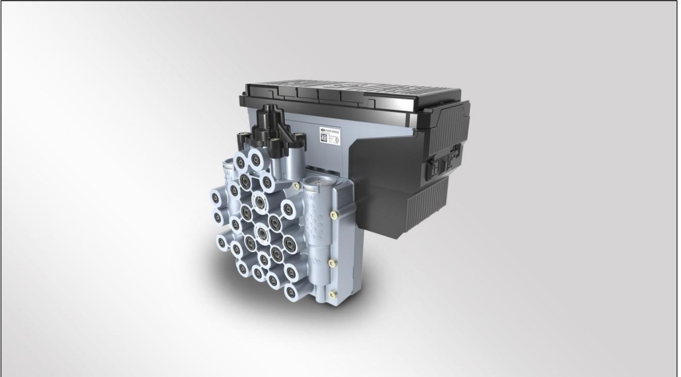
**Das intelligente, elektronische Trailer-Bremssystem iTEBS X kombiniert die elektronische Steuerungseinheit, Sensortechnologie und pneumatische Bremssteuerung sowie Bremsfunktionen wie ABS und lastabhängiges Bremsen in einer kompakten Baugruppe, die sich durch höchste Qualität und Zuverlässigkeit auszeichnet.**
