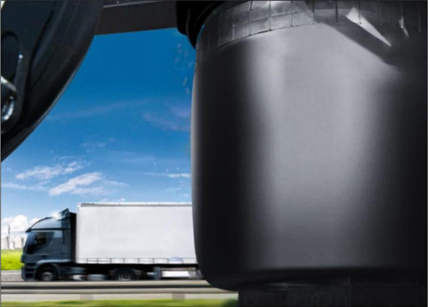
**Continental hat mit der Modellvariante N7 neue Nutzfahrzeug-Luftfedern entwickelt, die für einen breiten Temperaturbereich geeignet sind. Die Luftfedern können die ab Werk verbauten Tough RuNR-Luftfedern eins zu eins ersetzen und bieten hohe Flexibilität und Schutzeigenschaften unabhängig vom Außenklima.**
