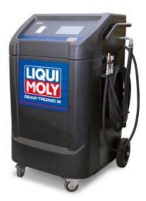
Früher waren die Spülung und der Wechsel des Getriebeöls aufwändige Prozesse. Heute gibt es moderne Lösungen wie beispielsweise das **Gear Tronic III** (siehe Bild) Gerät von LIQUI MOLY, das im Rahmen eines Werkstattkonzepts angeboten wird. Dieses Gerät ermöglicht einen automatischen Getriebeölservice, der auch eine gründliche Reinigung mit speziellen Additiven beinhaltet.
