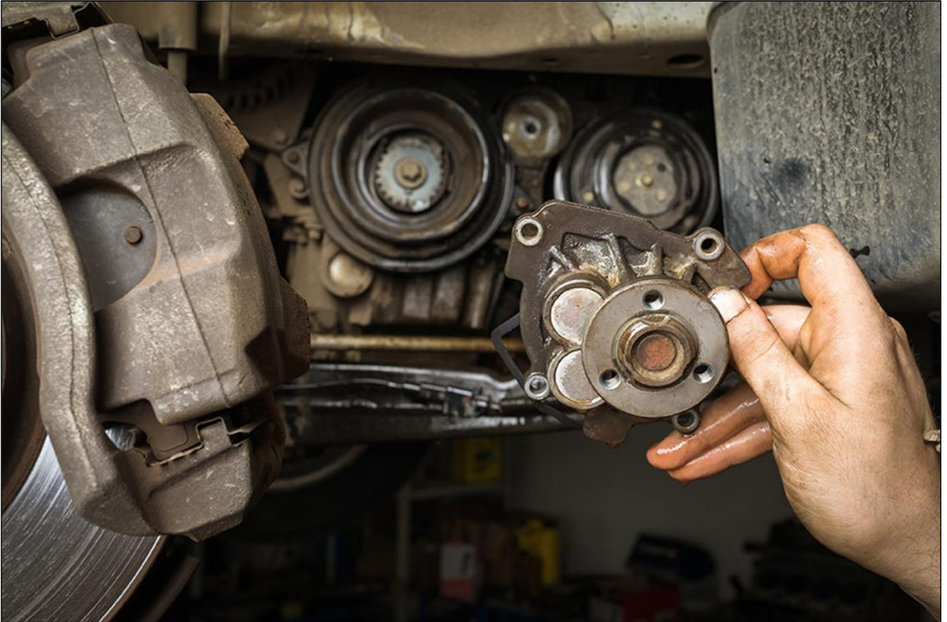
Um der Ausfall der Wasserpumpe zu vermeiden, wird diese häufig vorsorglich durch die Werkstatt ersetzt. Somit entgeht man einigen technischen Problemen:
