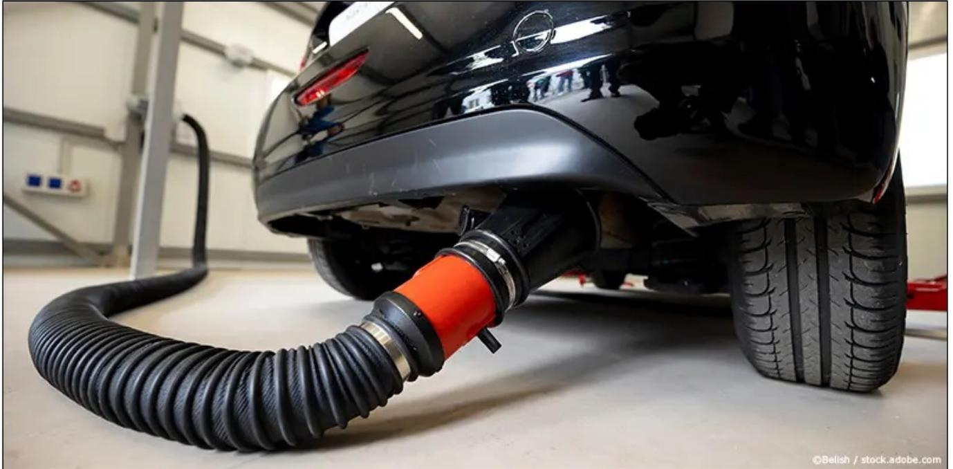
Seit Juli 2023 wird bei der Abgasuntersuchung (AU) für Euro-6/VI-Dieselfahrzeuge die Partikelmessung angewendet. Zuvor wurde mit dem Trübungsmessverfahren der Trübungswert im Abgas von Dieselfahrzeugen gemessen. Seit Juli 2023 reicht das für Fahrzeuge ab der Emissionsklasse Euro-6/VI nicht mehr aus: Das Partikelmessverfahren ist verpflichtend. Bei älteren Euro-4- und Euro-5-Fahrzeugen wird weiterhin die Trübung gemessen.
