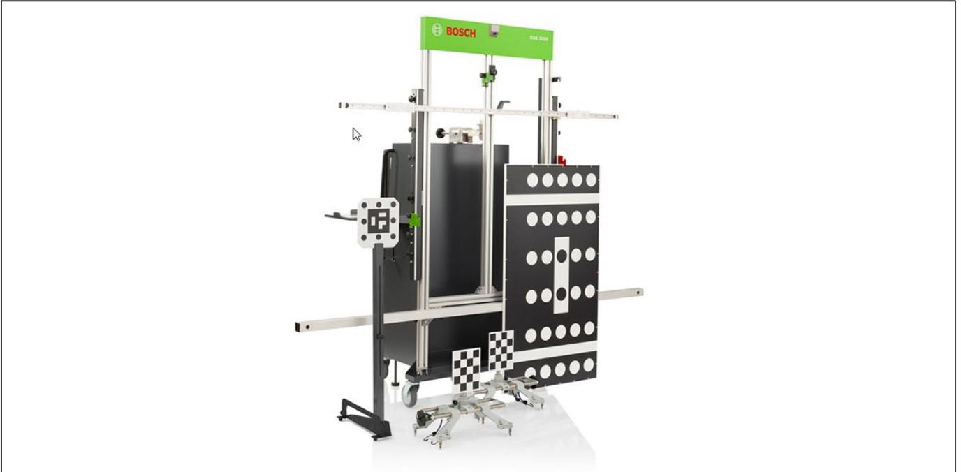
Moderne Pkw und Transporter sind heute zunehmend mit Fahrerassistenzsystemen ausgestattet, die mit Kamerasystemen und Radarsensoren kritische Situationen erkennen. Kfz-Werkstätten stehen damit immer häufiger vor der Aufgabe, die Systeme nach einer Reparatur oder Wartung neu zu kalibrieren.
