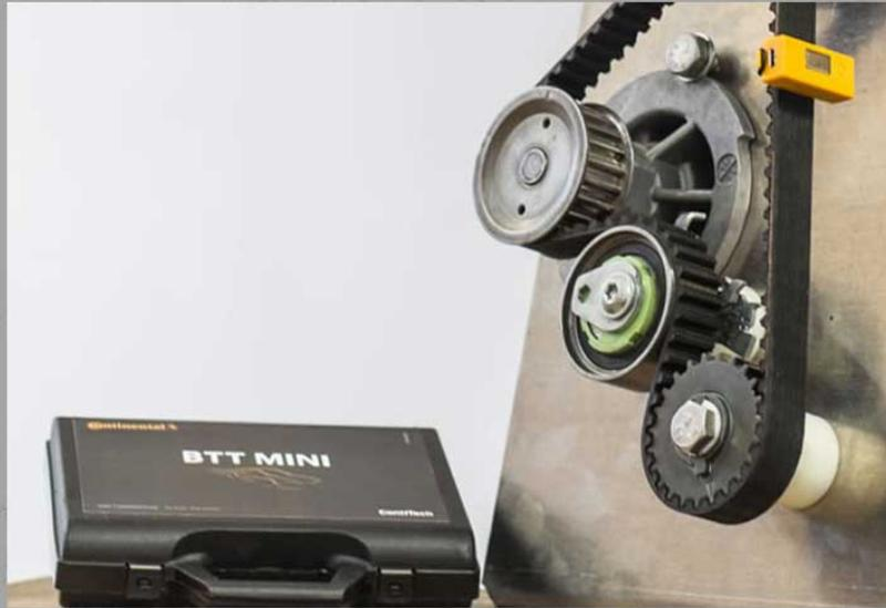
Das Frequenzmessegerät im Kompaktformat ist seit dem ersten Quartal 2017 auf dem Markt. Die ContiTech Power Transmission Group bietet den Werkstätten somit ein platzsparendes Frequenzmessgerät mit dessen Hilfe in nur wenigen Schritten die korrekte Spannung in Riemenantrieben gemessen und eingestellt werden kann.
