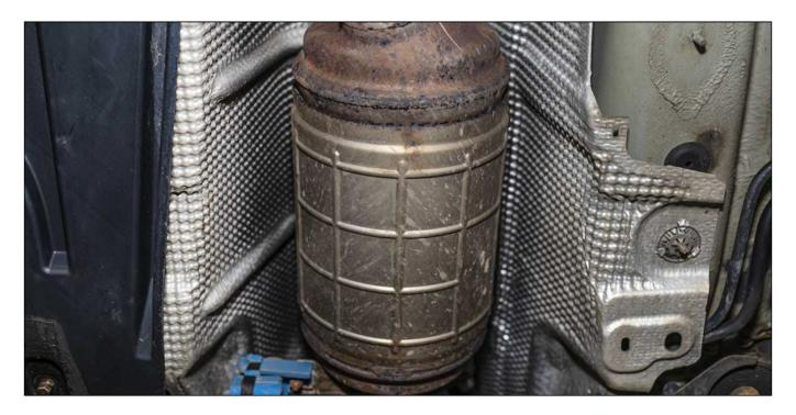
Bei modernen Dieselfahrzeugen ist er längst Stand der Dinge: Der <u>Dieselpartikelfilter</u> (<u>DPF</u>). Er sorgt dafür, dass die feinen Rußpartikel aus den Abgasen geholt werden und so keine Belastung für Mensch und Umwelt werden. Allseits bekannt ist auch, dass ein Diesel unbedingt im so genannten Mischbetrieb gefahren werden soll, da der Partikelfilter regelmäßig von den Rußteilchen freigebrannt werden muss.
