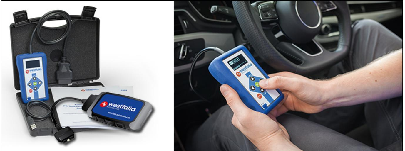
Im Zusammenhang mit dem Einbau einer Anhängerkupplung und eines fahrzeugspezifischen Elektrosatzes kann es erforderlich sein, das Fahrzeug auf den Anhängerbetrieb zu codieren. Dadurch werden die gesetzlich vorgeschriebenen Beleuchtungsfunktionen aktiviert und alle Komfortfunktionen wie die EPH-Abschaltung und die Nebelschlussleuchten-Umschaltung bereitgestellt.
