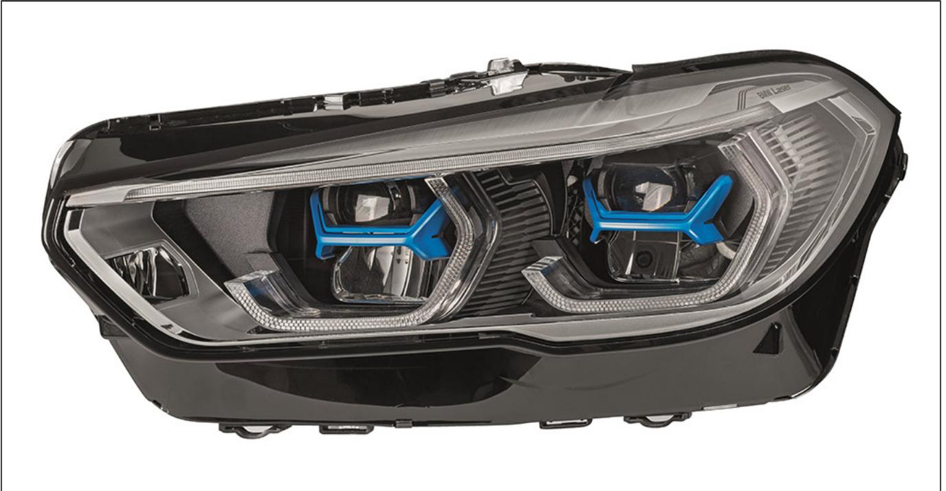
*Die neueste Generation von AL-Laserlichtscheinwerfern erlaubt dank flacher Bauweise der Lichtmodule, intelligenter Lichtsteuerung und strenger Sicherheitsvorkehrungen auch Laserlicht als Dauerfernlicht.*
