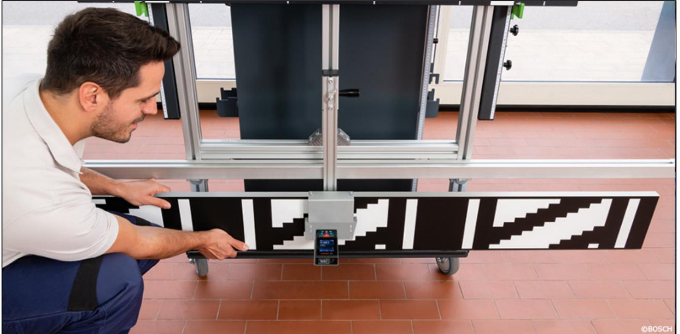
Die computergesteuerte **Kalibrier- und Justagevorrichtung DAS 3000** von **Bosch** ermöglicht Kfz-Werkstätten, Lidar-Sensoren präzise zu kalibrieren.
