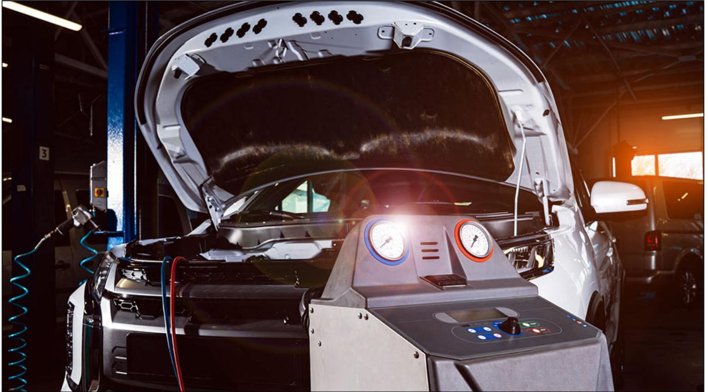
**Das für Klimaanlagen von Kraftfahrzeugen vielfach genutzte Kältemittel R134a darf aufgrund neuer EU-Richtlinien zum Umweltschutz seit Anfang 2011 nicht mehr in neu typgeprüften Fahrzeugen verwendet werden. Sein GWP-Wert (Global Warming Potential) von 1.430 überschreitet das gesetzlich festgelegte Limit um ein Zehnfaches. Die Treibhauswirkung von R134a beträgt das 1430-fache der gleichen Menge Kohlendioxid bezogen auf einen Zeithorizont von 100 Jahren.**
