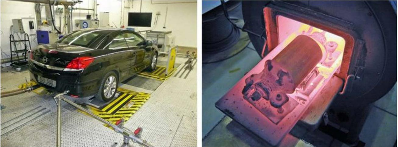
Tests des Umweltzeichens ‚Blauer Engel‘: Der Katalysator wird in einem Hochtemperaturofen hydrothermalen Bedingungen ausgesetzt und altert dadurch künstlich. Das simuliert eine für den ‚Blaue Engel‘-Emissionstest notwendige Laufleistung von etwa 160.000 km.
