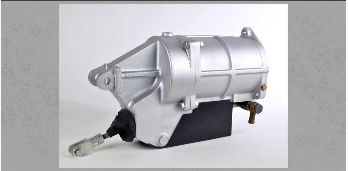
Die erste und wichtigste Sicherheitskomponente im Auto war die Bremse. Doch bereits in den 1920-Jahren waren die damaligen Bremsen dem Gewicht der Fahrzeuge nicht mehr gewachsen. Mit der pneumatischen Servobremse brachte Bosch im Jahr 1927 eine Bremse auf den Markt, die den Bremsweg der Fahrzeuge um ein Drittel verkürzte. Ein Jahr später entwickelte Bosch noch die Bremsunterstützungslösung Bremshelf.
