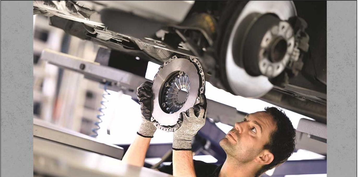
Eine Kupplungsmontage ist anspruchsvoll und zeitaufwendig, da dafür das Getriebe vom Motor getrennt werden muss. Oft wird ein kompletter Kupplungssatz verbaut, obwohl dieser kostenintensiv ist. Eine vorherige Expertenbeurteilung ist daher unabdingbar und minimiert den Aufwand erheblich. In diesem Artikel erfahren Sie, wie Werkstätten potenzielle Fehler insbesondere bei der Montage der Kupplung vermeiden können.
