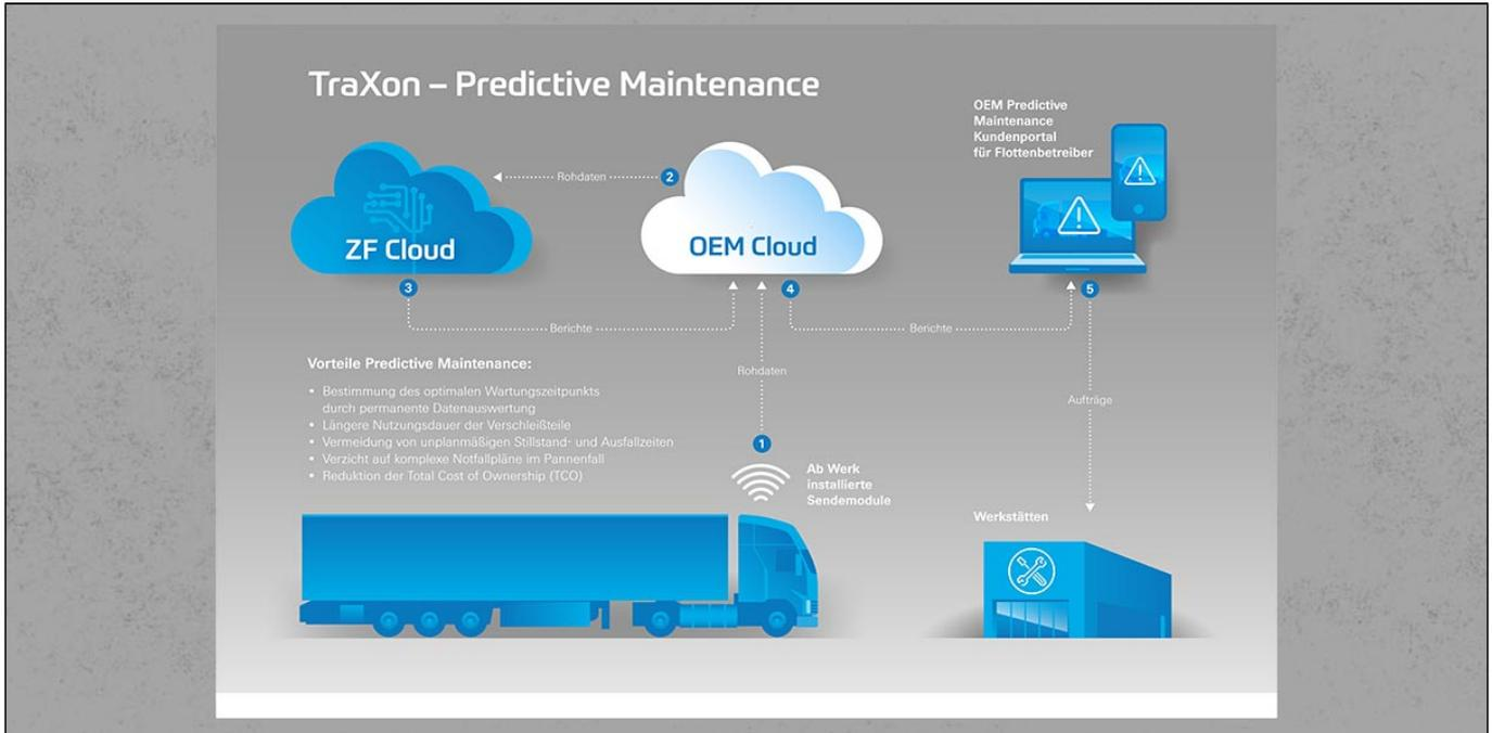
„Predictive Maintenance“ bedeutet vorrausschauende Wartung und ist für Flottenbesitzer längst ein Begriff. Wartungs- und Instandhaltungsintervalle von Motor und Getriebe lassen sich damit der tatsächlichen Abnutzung anpassen. Der Nutzfahrzeugzulieferer ZF will ab 2019 seine „Traxon“-Getriebe optional mit einer Predictive-Maintenance-Funktion ausliefern.
