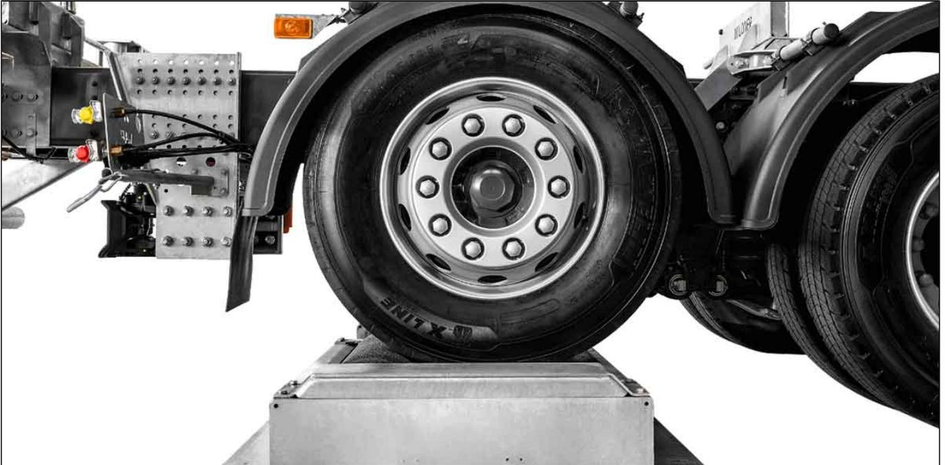
Bis Ende 2019 müssen alle Bremsprüfstände, die zur HU und SP verwendet werden, der aktuellen HU-Bremsenrichtlinie von 2011 entsprechen. Unter anderem wird dabei verlangt, dass bei der Bremsprüfung in den Bremszylindern ein Mindestdruck von 1,7 bar herrscht. Das kann bei Lkw mit ungünstigem Last-/Leer-Verhältnis unbeladen problematisch sein kann.
