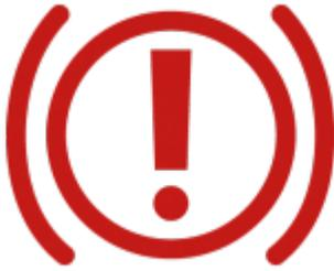
Es gibt ein Problem mit den Bremsen. Die Bremsbeläge sind abgefahren oder es befindet sich zu wenig Bremsflüssigkeit im Auto.
