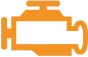
Die gelbe Kontrollleuchte mit dem Motorblock, ggf. mit Hinweis „CHECK“: deutet auf die Probleme mit der Motorsteuerung hin. Das Auto sollte in der Werkstatt überprüft werden.
