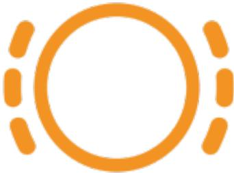
Es besteht keine akute Gefahr, aber die Bremsbeläge sind abgenutzt. Es sollte in Kürze eine Werkstatt aufgesucht werden.
