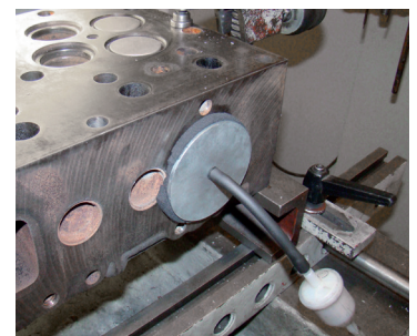
Abbildung 2: Dichtheitsprüfung des Ventilsitzes mit Unterdruck
