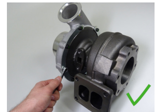
Abbildung 2: Spannschellen und Schrauben müssen zur Justage gelöst werden
