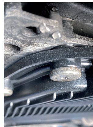
Abbildung 2: Beim Ansetzen Dichtung verschoben
