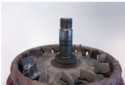
Abbildung 1: Abgeschliffene Welle im Lagerbereich
