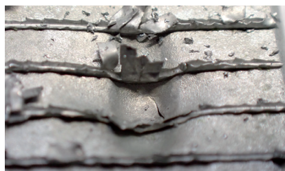
Abbildung 2: Deformation durch Eistropfen am Rohr des Verdampfers
