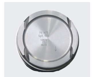
Abbildung 1: Auf dem Kolbenboden stehen der Durchmesser, das Einbauspiel und die Einbaurichtung
