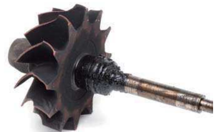
Abb. 3 Verkocktes Öl auf der Turbinenseite
