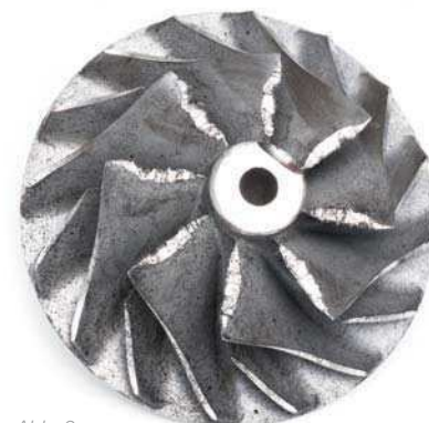
Abb. 2 Durch Fremdkörper beschädigtes Verdichterrad
