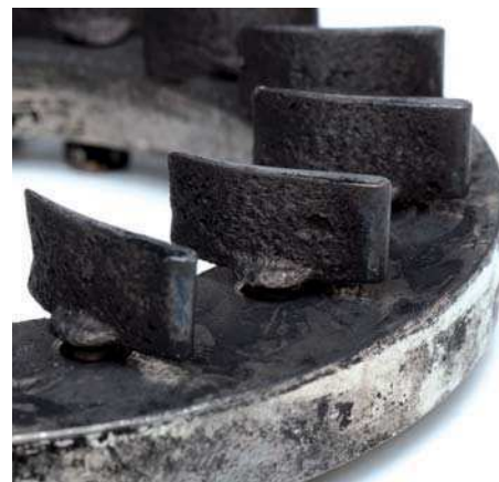
Abb. 1 Beschädigte Luftleitbleche der VTG-Einheit
