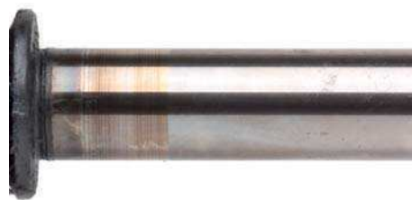
Abb. 4 Auf die Welle aufgeschweißtes Lagermaterial
