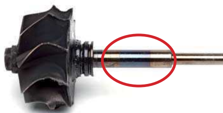
Abb. 3 Verfärbung des Wellenschafts
