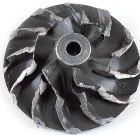
Abb. 1 Am Gehäuse angeschlagenes Verdichterrad
