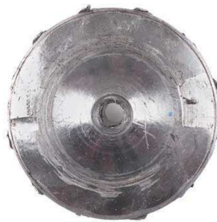
Abb. 1 Dellen auf der Rückseite des Verdichterrads
