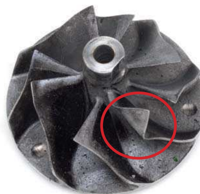
Abb. 4 Nur eine Fahne des Verdichterrads beschädigt
