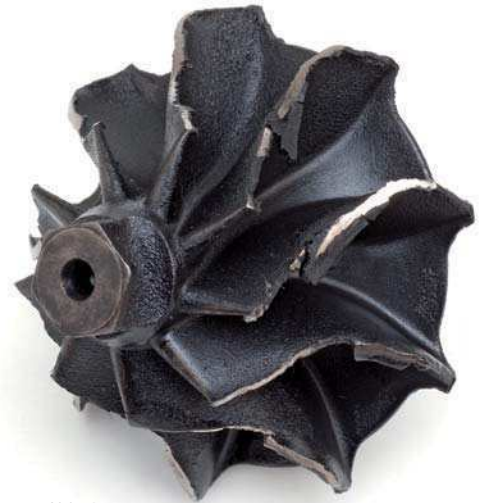
Abb. 2 An das Gehäuse angelaufenes Turbinenrad
