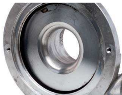
Abb. 2 Anlaufspuren im Verdichtergehäuse
