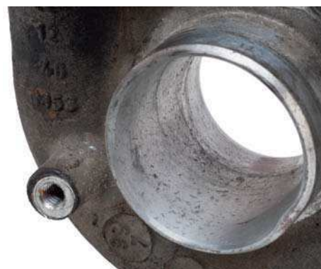
Abb. 3 Fremdkörpereinschläge im Ansaugkanal des Verdichtergehäuses
