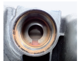
Abbildung 1: Ablagerungen im Kühlmittelgleichsbehälter
