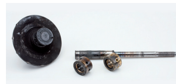
Abbildung 2: Gebrochene Läuferwelle durch eine Mangelschmierung der Radiallager
