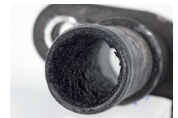
Abbildung 3: Durch eindringende Abgase verkockte Ölrücklaufleitung
