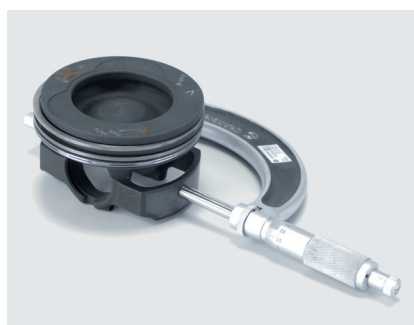
Abbildung 2: Die Beschichtung addiert ca. 0,03 mm bis 0,04 mm zum angegebenen Durchmesser
