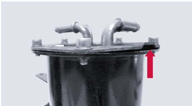
Abbildung 1: Bereich zum korrekten Abhebeln des Deckels
