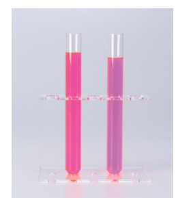
Abbildung 3: Kaum farblich zu unterscheiden, hier ein OAT (links) und ein HOAT (rechts).
